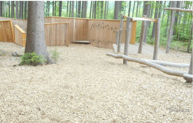
dopadová plocha – drevoštěpka k přírodnímu charakteru vhodný materiál možné využít hmotu z kácených stromů v areálu celý prostor
