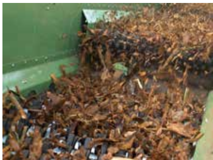
Obrázek č. 2: Nakypřování a třídění na hvězdicovém poli
