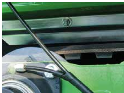
Obrázek č. 5: Ozubený vynášecí pás z násypky bunkru
