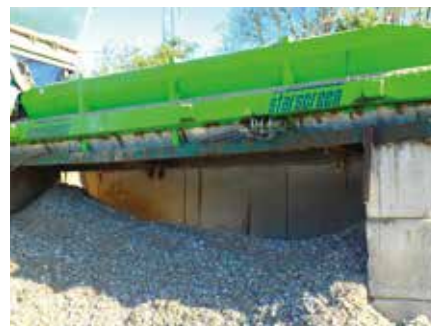
Obrázek č. 8: Stacionární hvězdicový třídič při zpracování TAP
