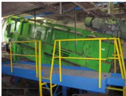
Obrázek č. 3: Stacionární třídič na štěpku
