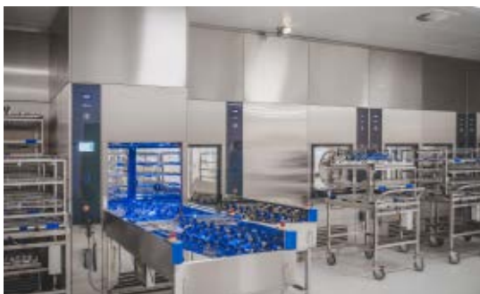
Pracoviště centrální sterilizace – jednodokorový a dvoudokorový dezinfikátor MMM, foto: archiv Nemocnice České Budějovice, a.s.
