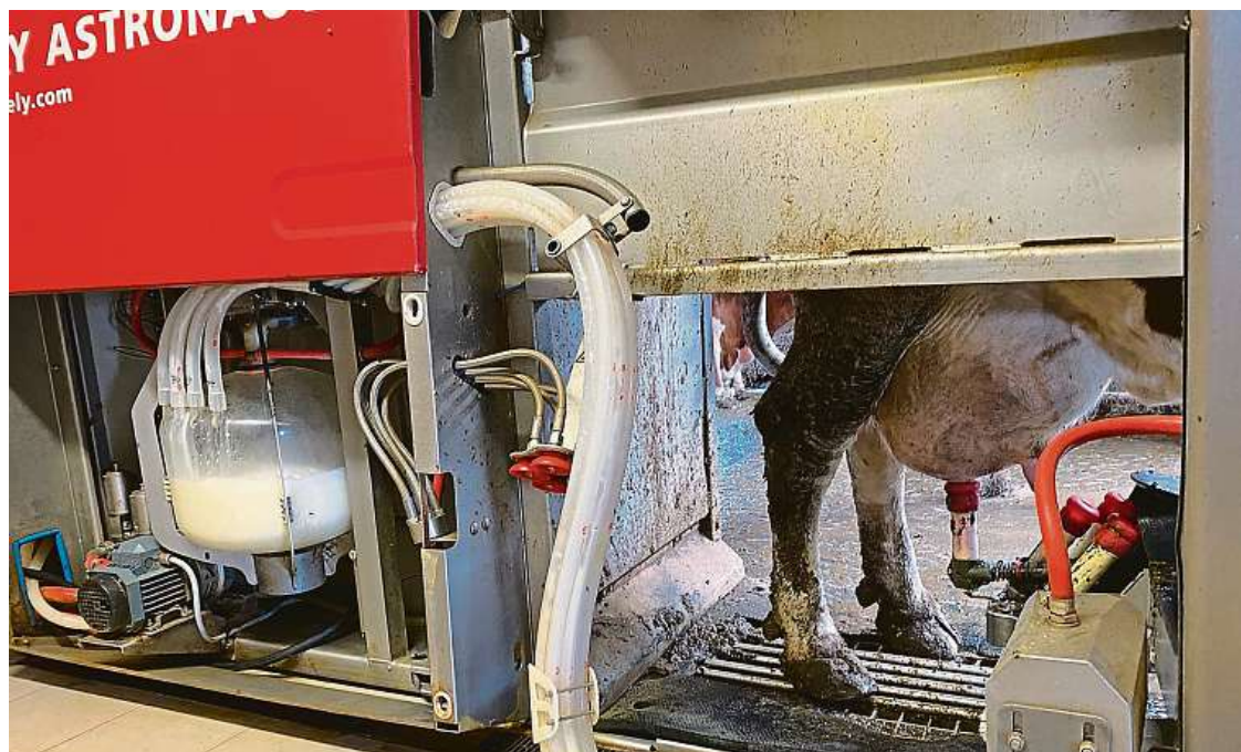
Systém dokáže pomocí čipu rozpoznat každou krávu. Ta u dojičního robota stráví jen několik minut. Zkušenosti s navrhováním plně automatizovaných systémů sbírají pracovníci firmy už od roku 2001.
