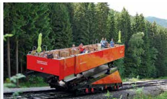
Pozemní lanovka v Duryňském lese překonává výšku 300 metrů a její trať má sklon až 250 promile. Vozí i železniční vagony
